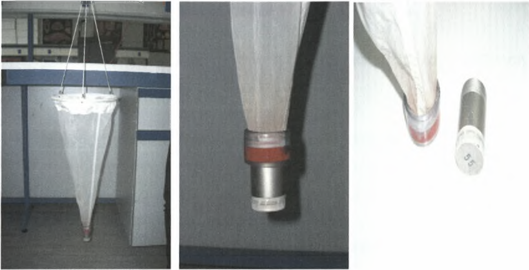
Εικόνα 8 : Κωνικό πλαγκτονικό δίκτυο με δοχείο συμπύκνωσης – συλλεκτήρα
