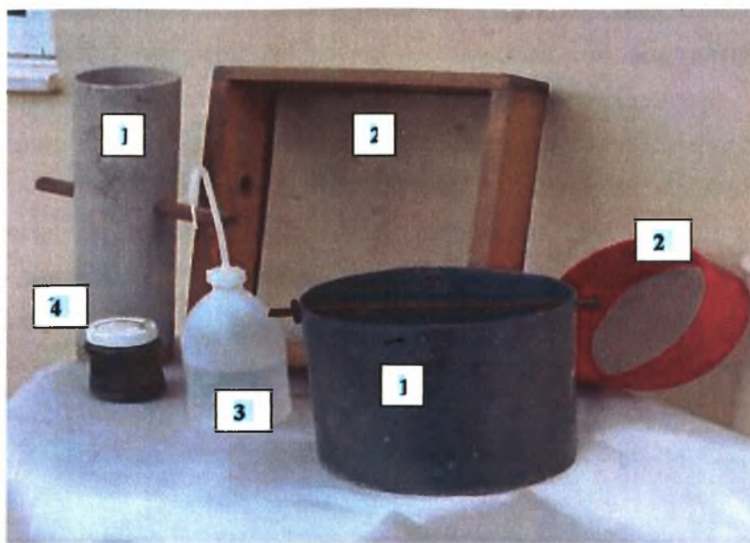
Σχήμα 8. Τα απαραίτητα υλικά για τη διεξαγωγή της έρευνας (1. Δειγματολήπτες, 2. Κόσκινα, 3. Υδροβολέας, 4. Βάζο δείγματος).
