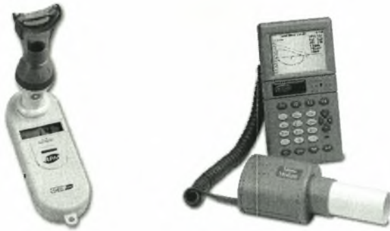
Εικόνα 1. Οι συσκευές προσδιορισμού των αναπνευστικών μεταβλητών. Συσκευή στοματικών πιέσεων MicroRPM (αριστερά) και σπιρόμετρο MicroLoop II (δεξιά).
