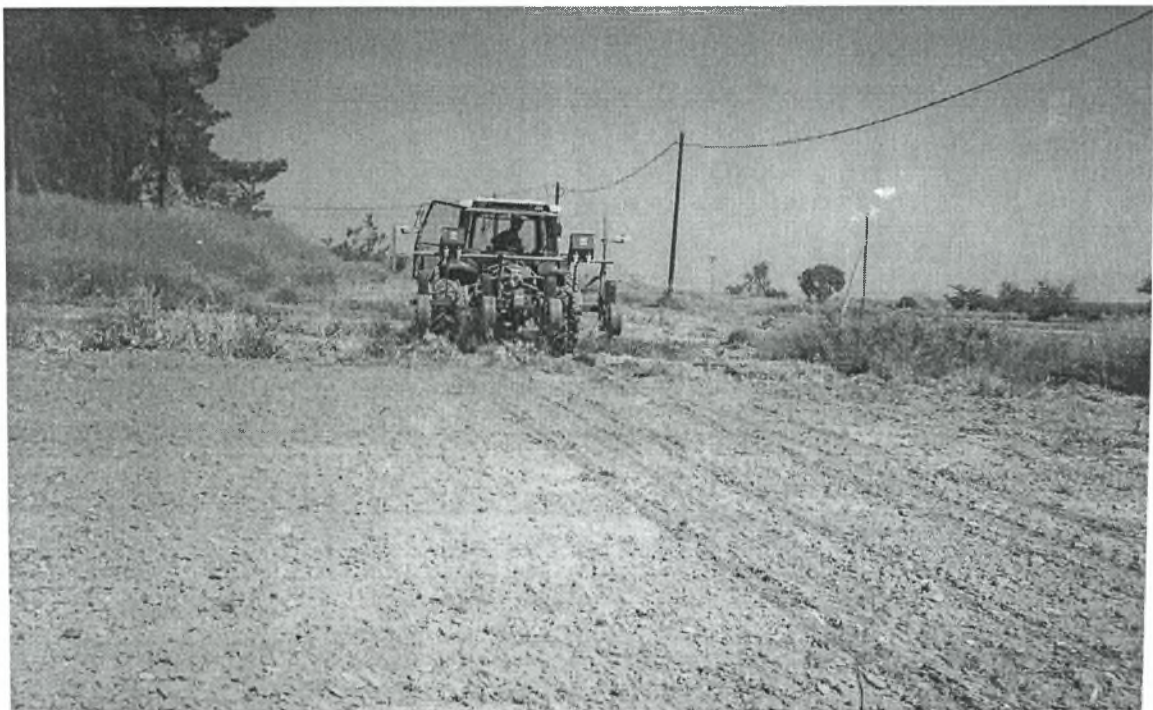
Εικόνα 4.2 Πνευματική μηχανή σποράς βαμβακιού.
