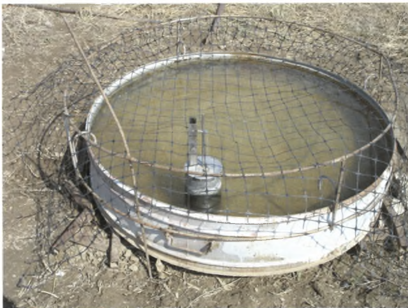
Εικόνα 3.10 Εξατμισόμετρο τύπου A
