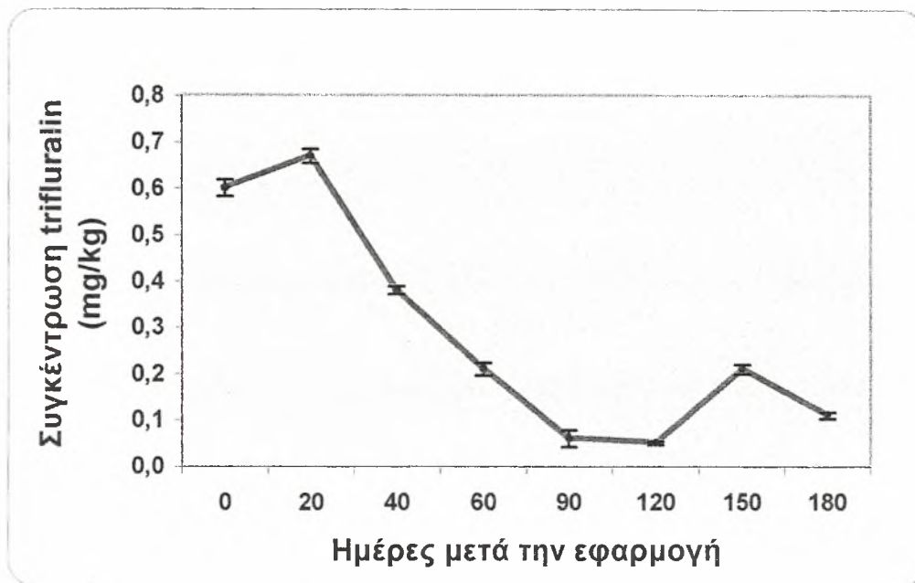
Σχ.5: Η μεταβολή της συγκέντρωσης του trifluralin σε διάφορους χρόνους μετά την εφαρμογή του στον επίπεδο αγρό
