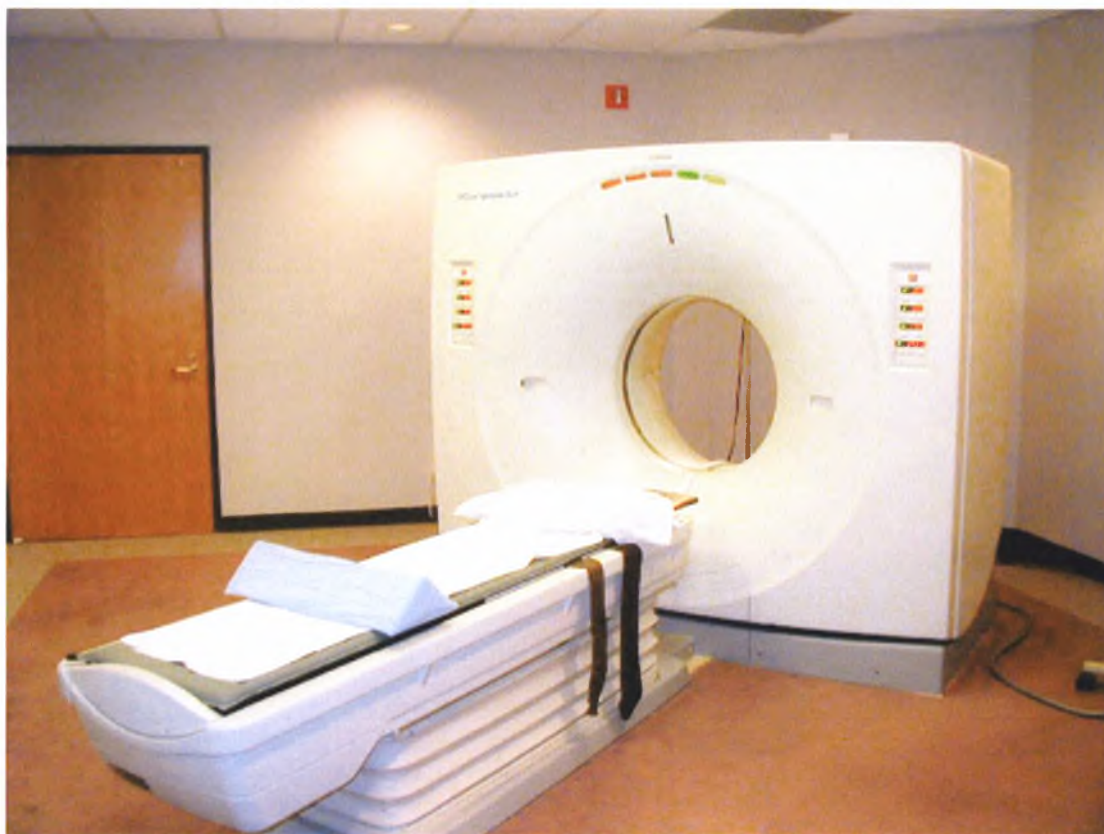
Εικόνα 1: Αξονικός τομογράφος. Παρατηρούμε το κρεβάτι για τον ασθενή και την κυκλική διατομή από την οποία εισέρχεται και πραγματοποιείται η σάρωση
