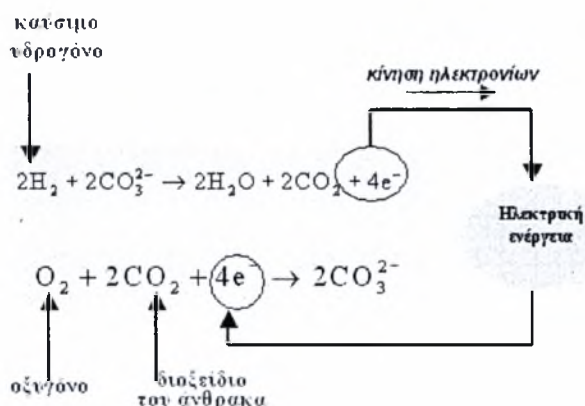
Σχήμα 2-6 Κυψέλη καυσίμου τηγμένων ανθρακικών αλάτων.
