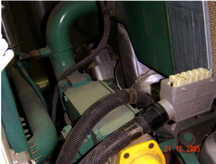
Φωτογραφία 3.3: Σύστημα μίξης αερα-καυσιμου (κουτι με δικτυωτο πλεγμα ενω φαινεται και ο κυλινδρος α8 απο τη μια πλευρα της μηχανης).συνολικα υπαρχουν 4 σταθμοι μογματος αερα-καυσιμου.
