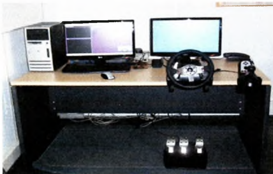
Εικόνα 3.1: Περιφερειακά συστήματα του προσομοιωτή οδήγησης STISIM Drive 100.
