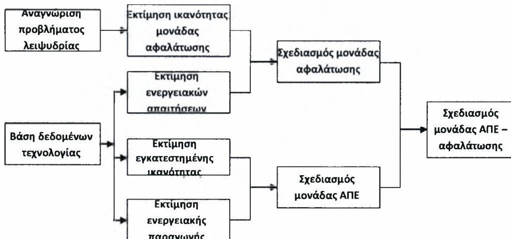
Εικόνα 21. Σχεδιασμός κατάλληλης μονάδας ΑΠΕ-αφαλάτωσης (Eltawil et al., 2009; Voivontas et al., 1999).
