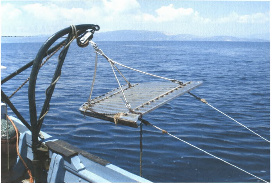
Εικόνα 2.6. Υδραετός (πόρτα) μηχανότρατας βυθού (φωτογραφία συγγραφέα)
