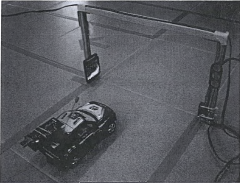
Εικόνα 5.21: Εγκατάσταση σημείου ελέγχου φωτεινού σηματοδότη, στην πειραματική διάταξη (1)
