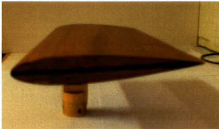
Εικόνα 3.1 Μοντέλο πτέρυγας και προσαρμογέας αισθητήρα
