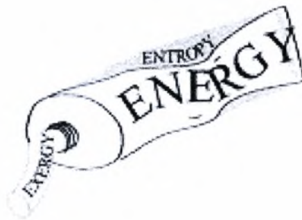
Σχήμα 3.3: Η ενέργεια ισούται με το άθροισμα εξέργειας και ανέργειας.
