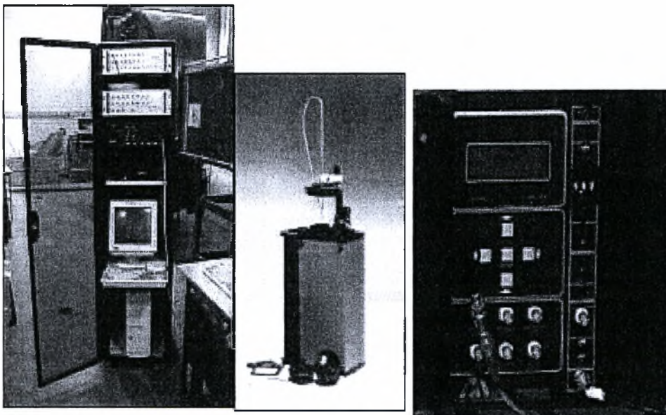
Εικόνα 3.6: Σύστημα Θερμικού Ανεμομέτρου και σύστημα Aalabs AN - 1005
