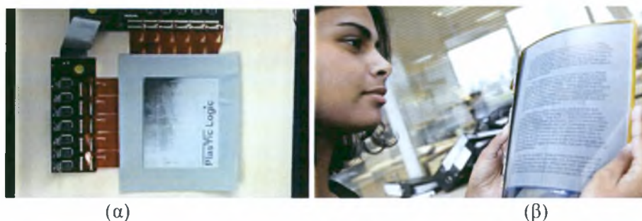
Εικόνα 5 (α) Πρωτότυπη εύκαμπτη οθόνη, και (β) παράδειγμα χρήσης
