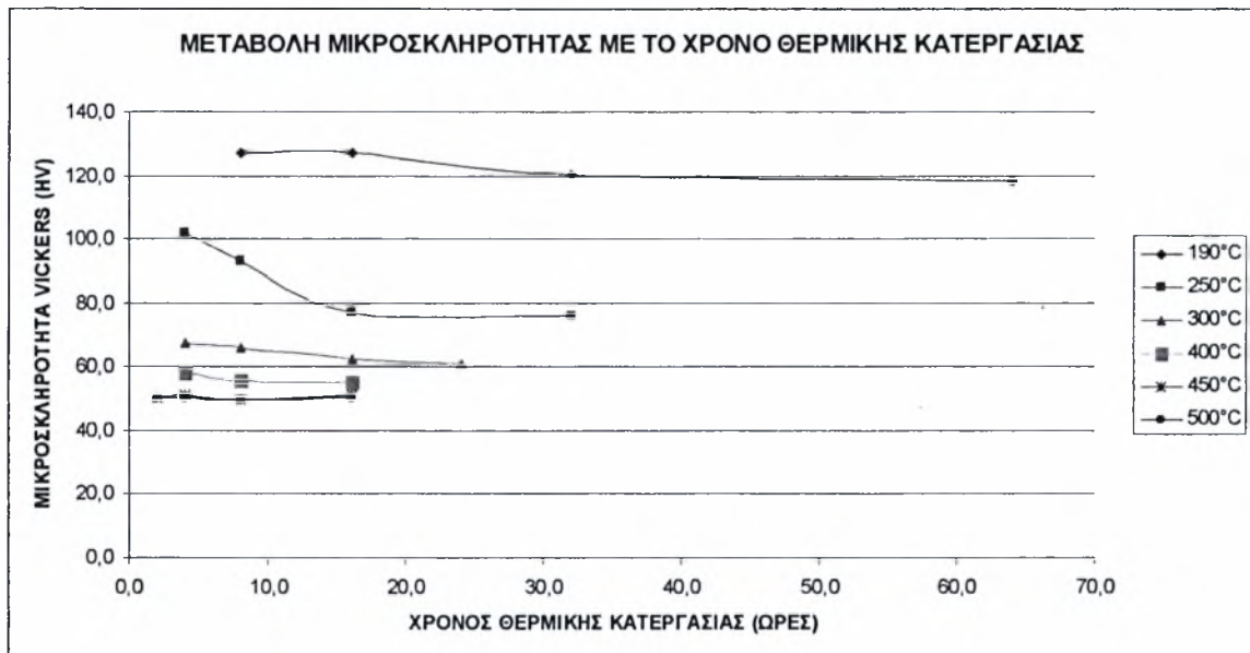
Διάγραμμα 3.13 – Μεταβολή της μικροσκληρότητας κράματος 6013-T6 με το χρόνο θερμικής κατεργασίας.
