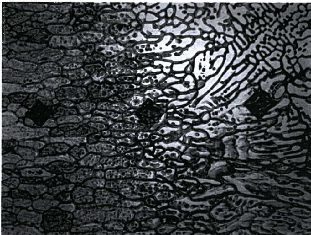
Εικόνα 2.8 – Μικροδομή Περιοχής Συγκόλλησης και ΘΕΖ Κοντά σε Αυτή
