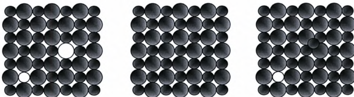
Σχήμα 2.9: Δομή τέλειου κρυστάλλου (β), αταξίες τύπου Schottky (α) και τύπου Frenkel (γ).
