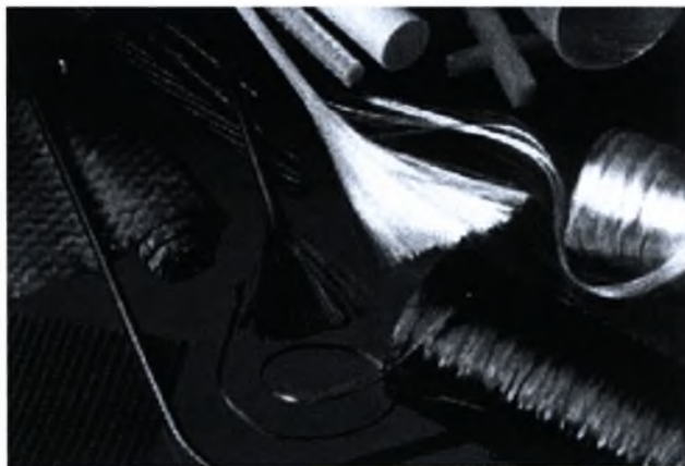
Σχήμα 1.1: Συνήθεις ίνες άνθρακα και γυαλιού και ινοπλισμένα πολυμερή (FRP)
