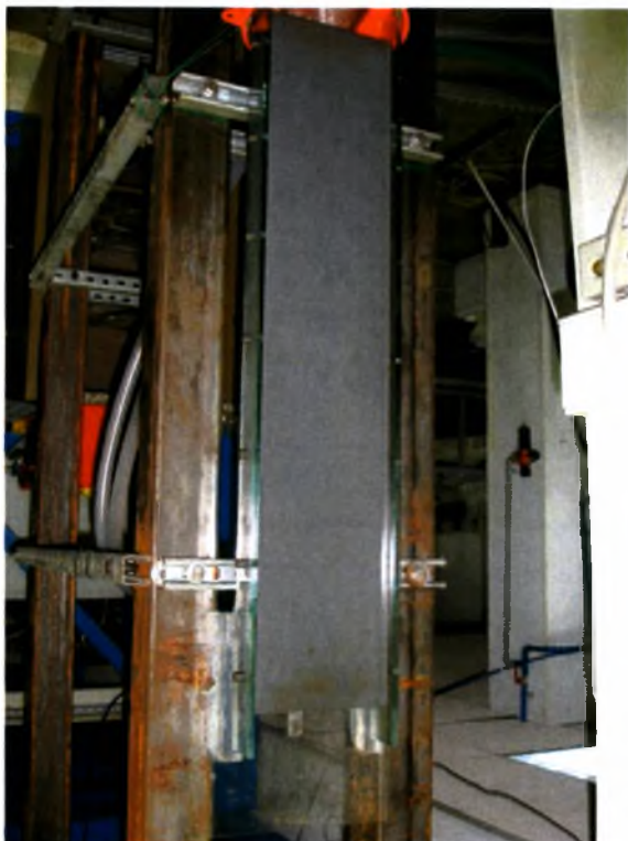
εικόνα 3.1. Κανάλι ροής (πλάκα PVC)
