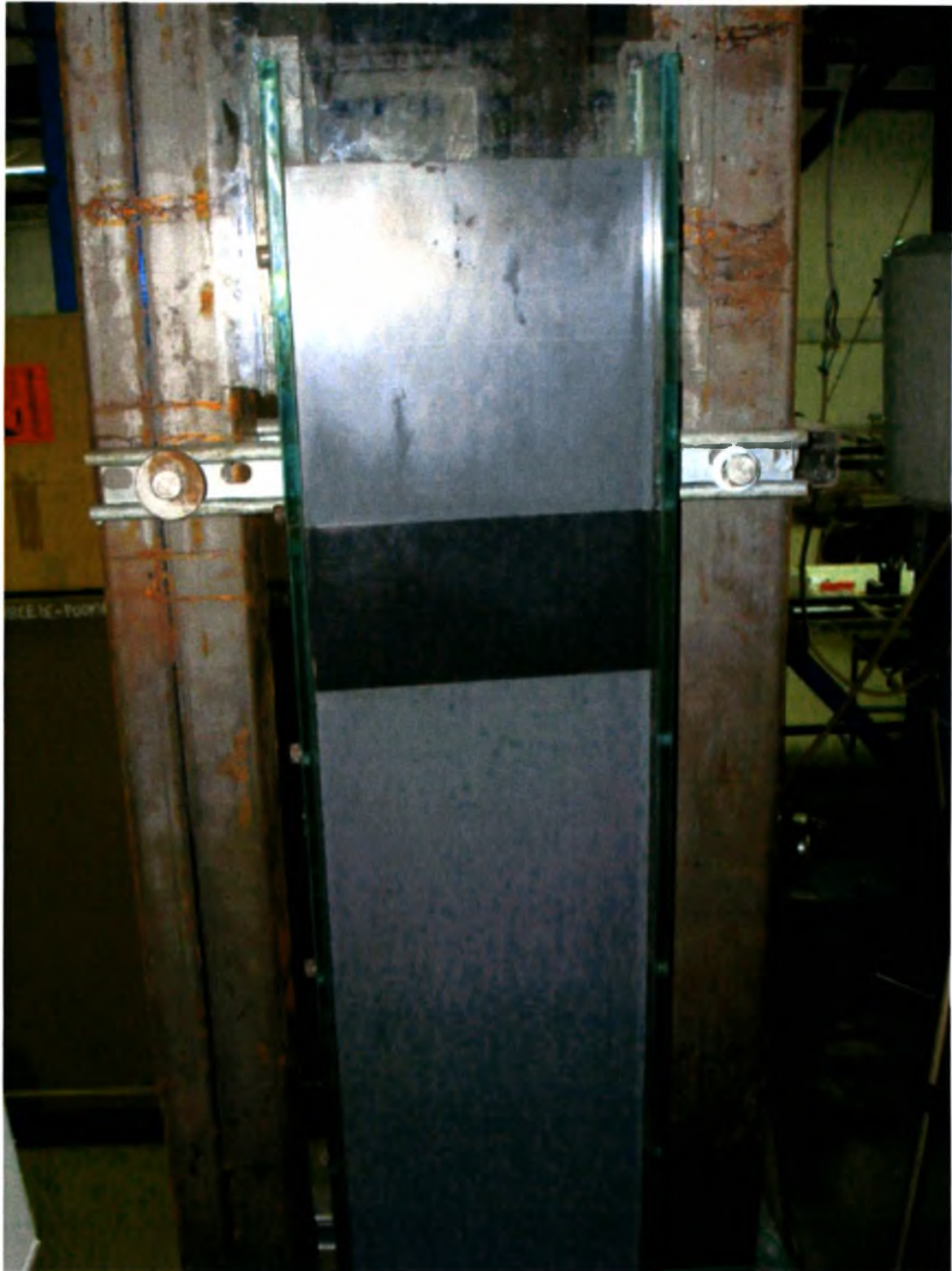
εικόνα 3.2. Κανάλι ροής με την πρόσθεση του αναβαθμού
