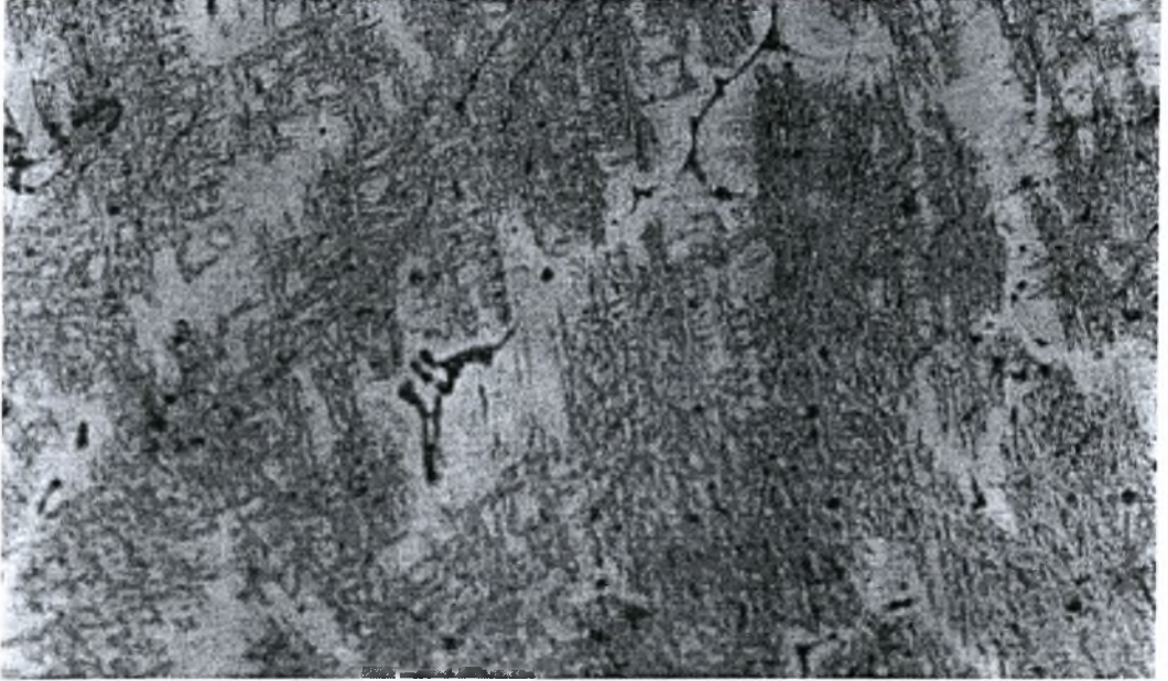
Σχ. 3.8.11 Φωτογραφία χάλυβα X20CrNi17-2, x200
