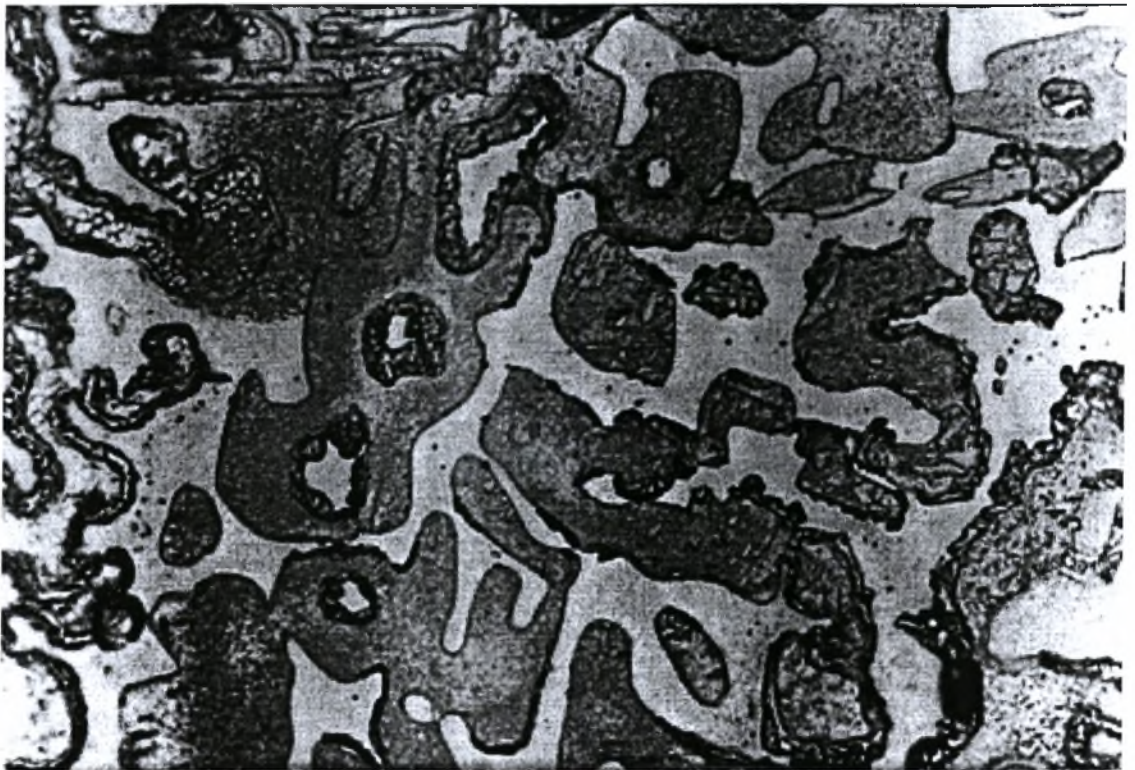
Σχ. 3.2.2 Φωτογραφία χάλυβα GX40CrNiSi27-4, x500
