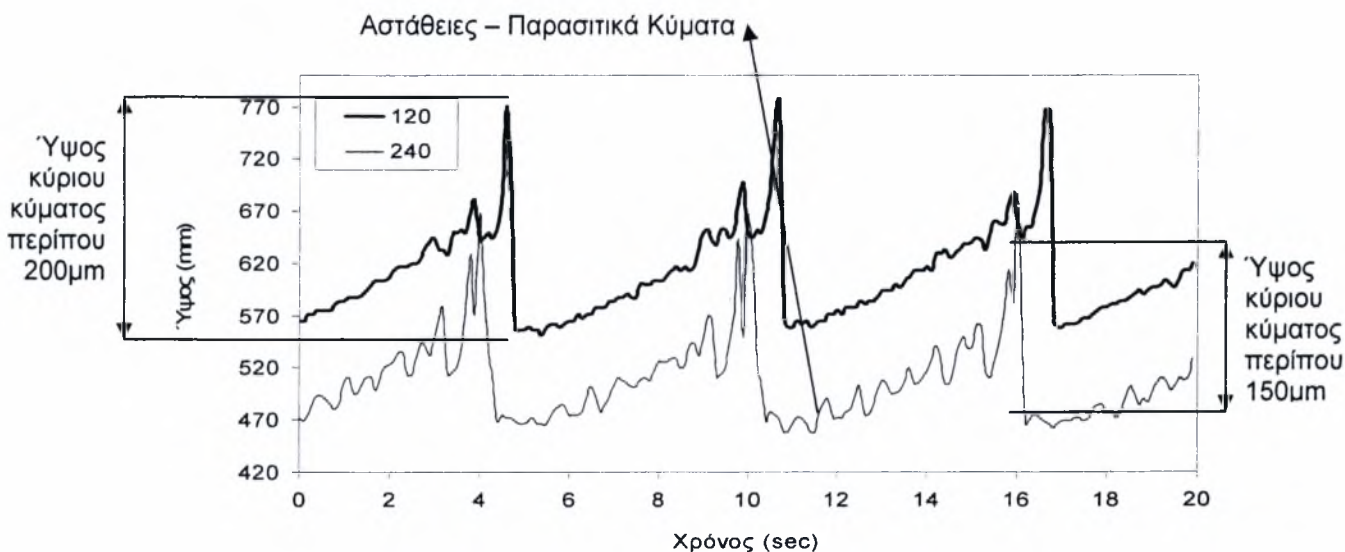
Σχήμα 4.28: Σύγκριση των χρονοσειρών του πάχους του υμένα για δύο διαφορετικά πλάτη του καναλιού ροής ( w=120\text{mm} & w=240\text{mm} ), για αριθμό Re=40 , συχνότητα διαταραχής f=0.167 (on 5 – off 1) και απόσταση a=330\text{mm} από την αρχή του καναλιού.
