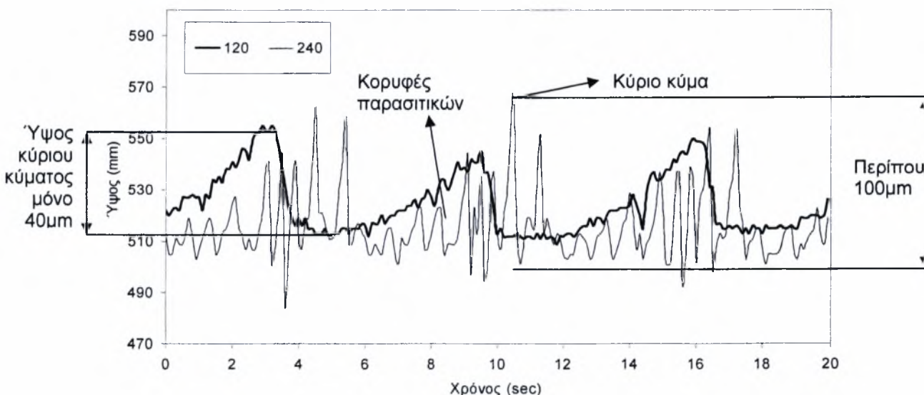
Σχήμα 4.29: Σύγκριση των χρονοσειρών του πάχους του υμένα για δύο διαφορετικά πλάτη του καναλιού ροής ( w=120\text{mm} & w=240\text{mm} ), για αριθμό Re=30 , συχνότητα διαταραχής f=0.167 (on 5 – off 1) και απόσταση b=1330\text{mm} από την αρχή του καναλιού.
