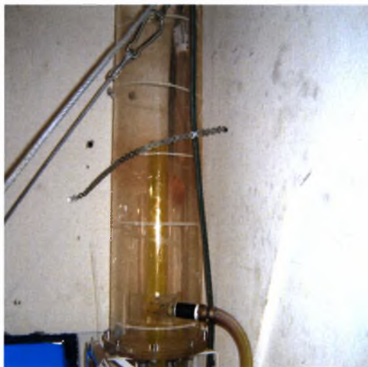
Σχήμα 3.2: Το δοχείο παροχής υγρού στο κανάλι
