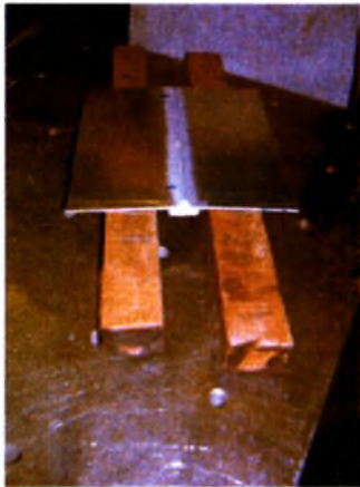
Εικόνα 3.4 Δοκίμιο έτοιμο προς συγκόλληση
