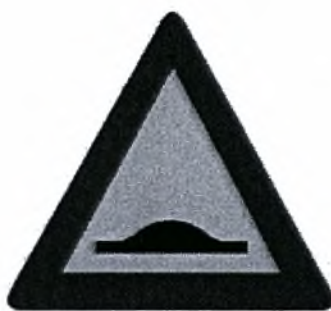
K-10 Επικίνδυνα υπερυψωμένο οδόστρωμα ή απότομη κυρτή αλλαγή της κατά μήκος κλίσης της οδού
