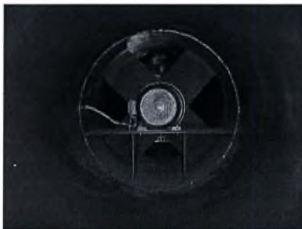
Φωτογραφία 4.1 Πτερωτή αεροσήραγγας EP&S
