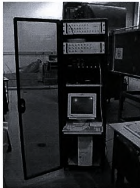
Σχήμα 4.4 Το Σύστημα Ανεμομετρίας Θερμού Σύρματος του Εργ. Ρ&Σ
