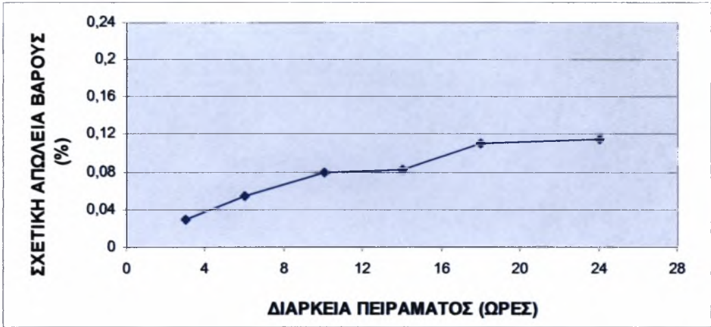
Διάγραμμα 7.7 Μεταβολή της σχετικής (%) απώλειας βάρους των τεμαχίων επιφάνειας 3 του χάλυβα 42CrMo4
