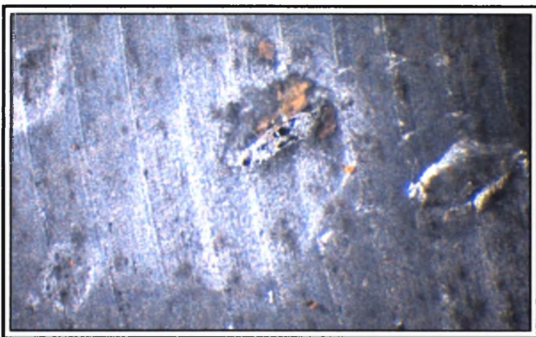
Εικόνα 6.61 Στερεοσκοπία του δοκμίου 1.4 του υλικού 50CrV4 μετά την πειραματική διαδικασία Τρηματική διάβρωση. (x 40)
