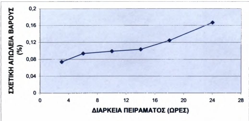
Διάγραμμα 7.22 Μεταβολή της σχετικής (%)απώλειας βάρους των τεμαχίων επιφάνειας 3 του χάλυβα 34CrNiMo6
