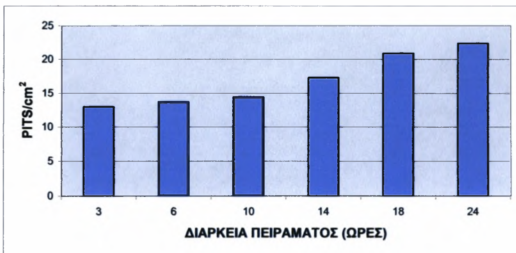
Διάγραμμα 7.38 Μεταβολή των pits/cm 2 των τεμαχίων επιφάνειας 3 του χάλυβα 50CrV4
