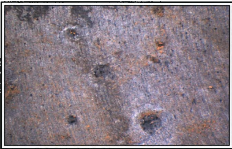
Στερεοσκοπία του δοκμίου 4.6 του υλικού 50CrV4 μετά την πειραματική διαδικασία. Τρηματική διάβρωση. (x 40)
