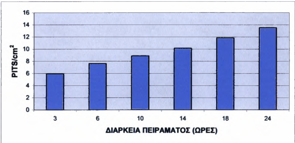
Διάγραμμα 7.26 Μεταβολή των pits/cm 2 των τεμαχίων επιφάνειας 4 του χάλυβα 34CrNiMo6
