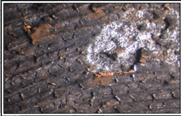
Στερεοσκοπία του δοκμίου 2.5 του υλικού 42CrMo4 μετά την πειραματική διαδικασία. Τρηματική διάβρωση. (x 40)
