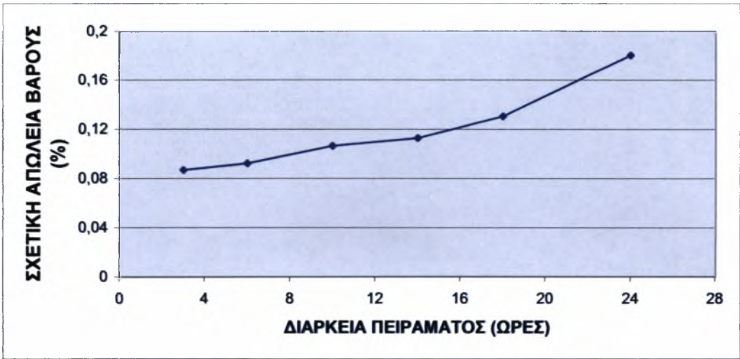
Διάγραμμα 7.25 Μεταβολή της σχετικής (%) απώλειας βάρους των τεμαχίων επιφάνειας 4 του χάλυβα 34CrNiMo6
