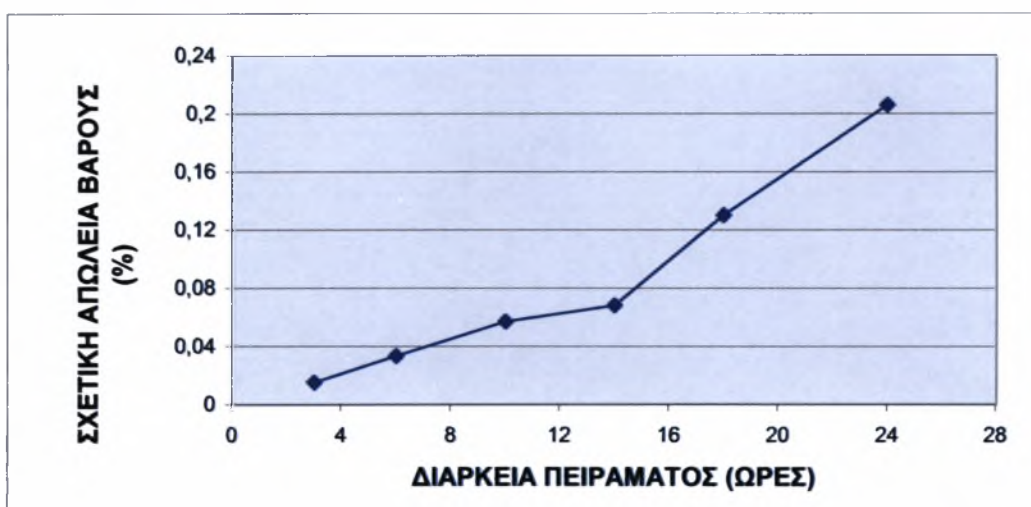
Διάγραμμα 7.19 Μεταβολή της σχετικής (%) απώλειας βάρους των τεμαχίων επιφάνειας 2 του χάλυβα 34CrNiMo6
