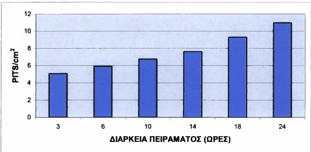
Διάγραμμα 7.23 Μεταβολή των pits/cm 2 των τεμαχίων επιφάνειας 3 του χάλυβα 34CrNiMo6
