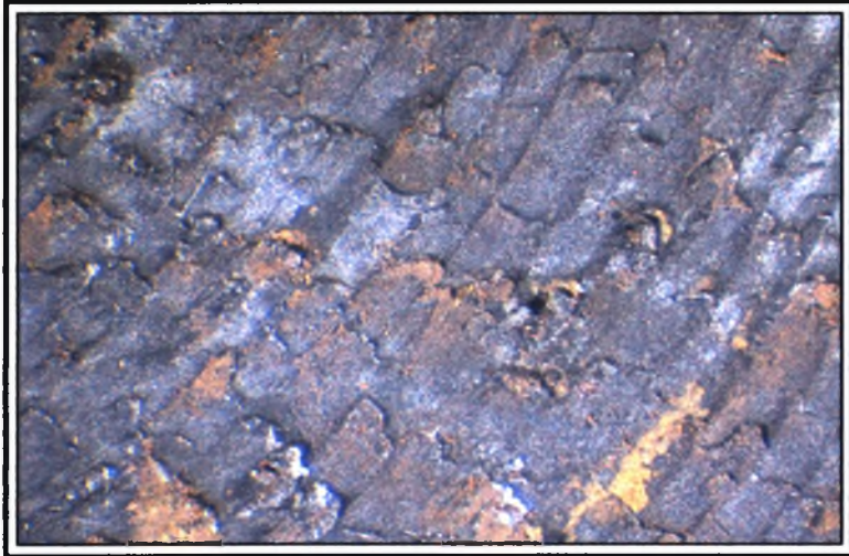
Εικόνα 6.67 Στερεοσκοπία του δοκιμίου 2.3 του υλικού 50CrV4 μετά την πειραματική διαδικασία. Τρηματική διάβρωση. (x 40)
