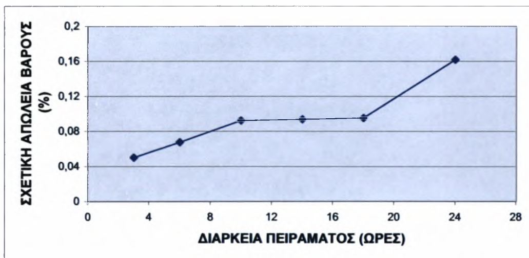
Διάγραμμα 7.37 Μεταβολή της σχετικής (%) απώλειας βάρους των τεμαχίων επιφάνειας 3 του χάλυβα 50CrV4
