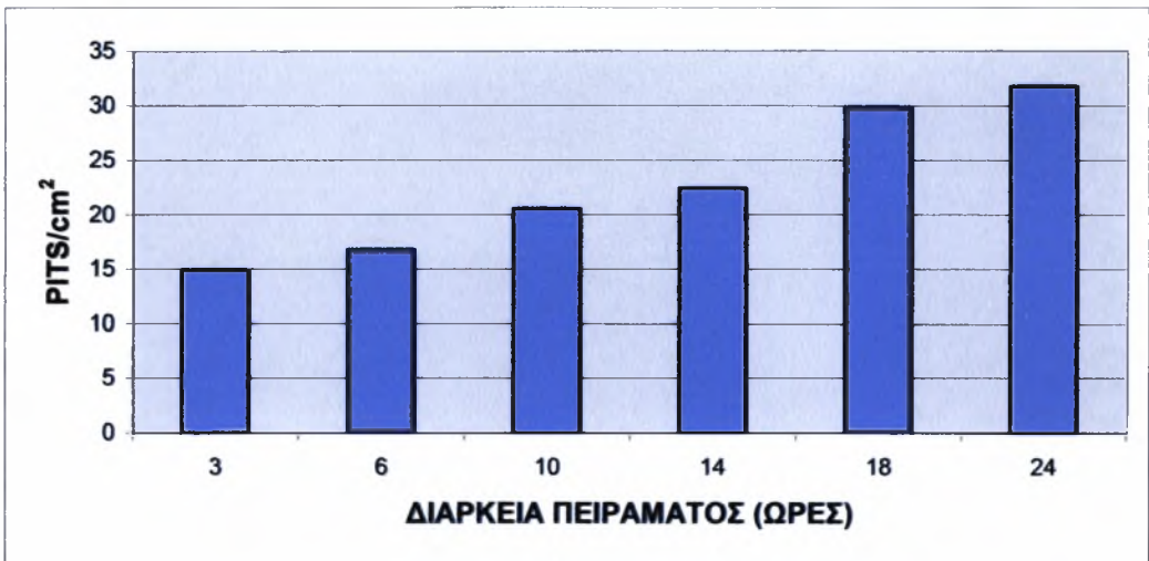
Διάγραμμα 7.8 Μεταβολή των pits/cm 2 των τεμαχίων επιφάνειας 3 του χάλυβα 42CrMo4
