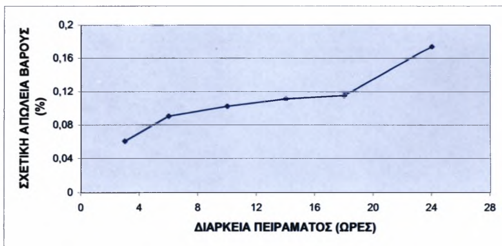
Διάγραμμα 7.34 Μεταβολή της σχετικής (%) απώλειας βάρους των τεμαχίων επιφανείας 2 του χάλυβα 50CrV4
