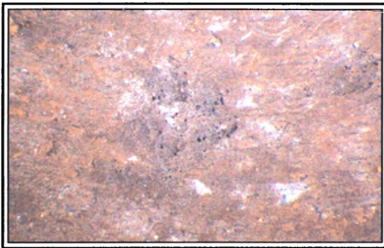
Στερεοσκοπία του δοκμίου 4.5 του υλικού 42CrMo4 μετά την πειραματική διαδικασία. Τρηματική διάβρωση. (x 40)
