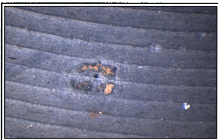
Στερεοσκοπία του δοκμίου 1.2 του υλικού 50CrV4 μετά την πειραματική διαδικασία. Τρηματική διάβρωση. (x 40)
