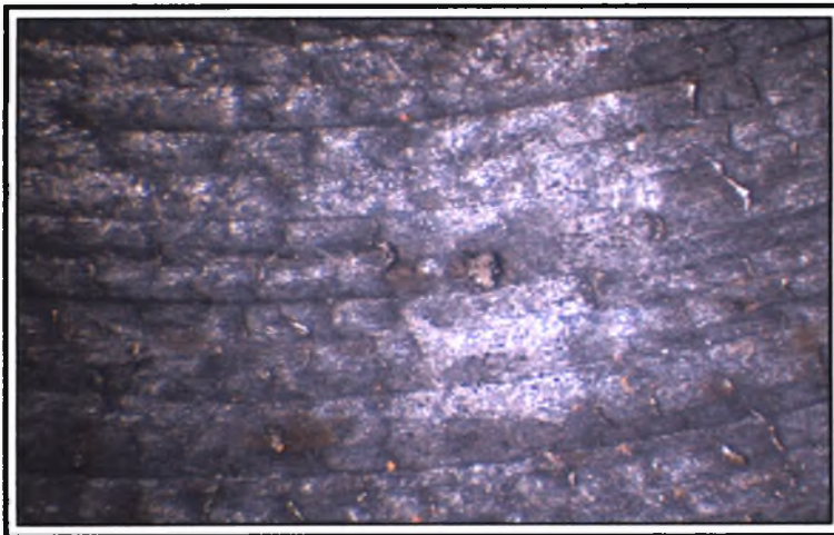
Στερεοσκοπία του δοκμίου 2.6 του υλικού 42CrMo4 μετά την πειραματική διαδικασία. Τρηματική διάβρωση. (x 40)
