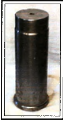
Εικόνα 4.1 Άξονας κατασκευασμένος από το υλικό 42CrMo4
