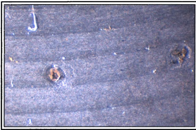
Εικόνα 6.59 Στερεοσκοπία του δοκιμίου 1.2 του υλικού 50CrV4 μετά την πειραματική διαδικασία. Τρηματική διάβρωση. (x 40)
