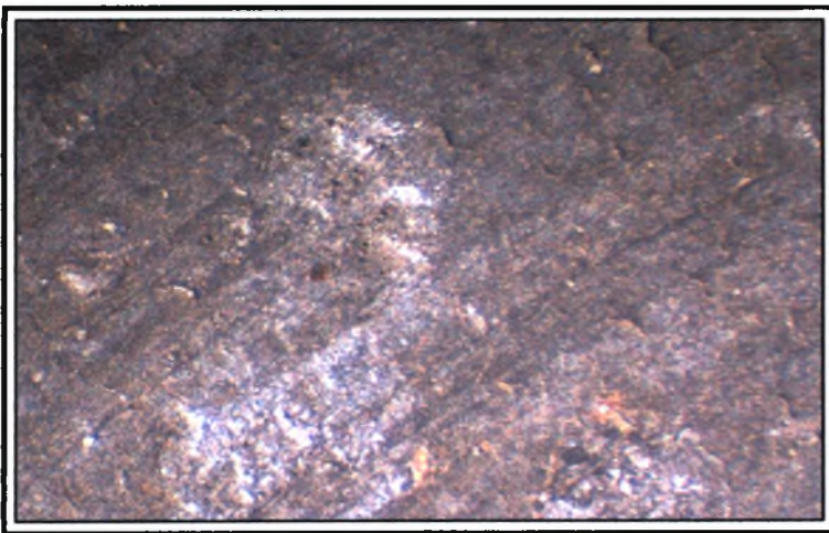
Σtereοσκοπία του δοκιμίου 2.3 του υλικού 42CrMo4 μετά την πειραματική διαδικασία. Τρηματική διάβρωση. (x 40)
