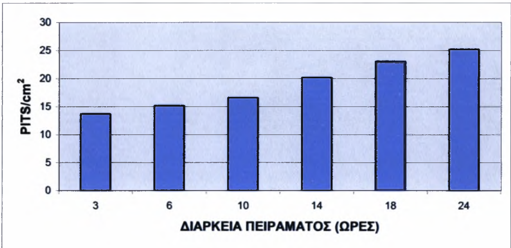
Διάγραμμα 7.41 Μεταβολή των pits/cm 2 των τεμαχίων επιφάνειας 4 του χάλυβα 50CrV4
