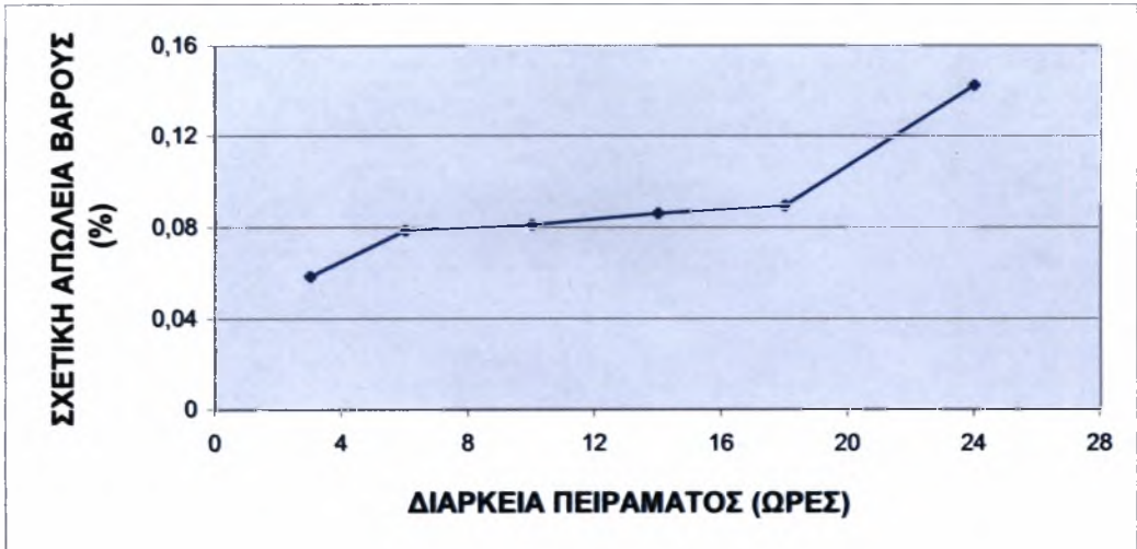
Διάγραμμα 7.31 Μεταβολή της σχετικής (%) απώλειας βάρους των τεμαχίων επιφάνειας 1 του χάλυβα 50CrV4
