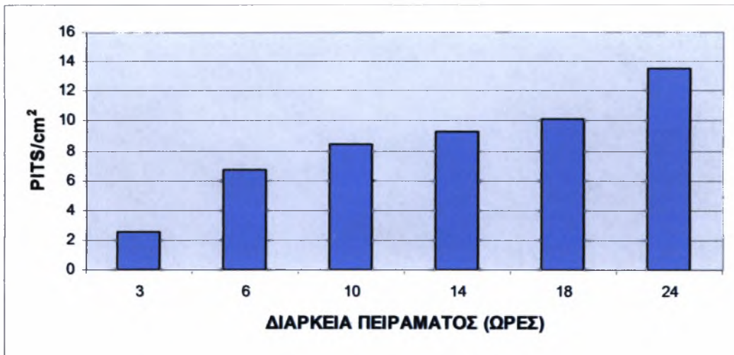
Διάγραμμα 7.17 Μεταβολή των pits/cm 2 των τεμαχίων επιφάνειας 1 του χάλυβα 34CrNiMo6
