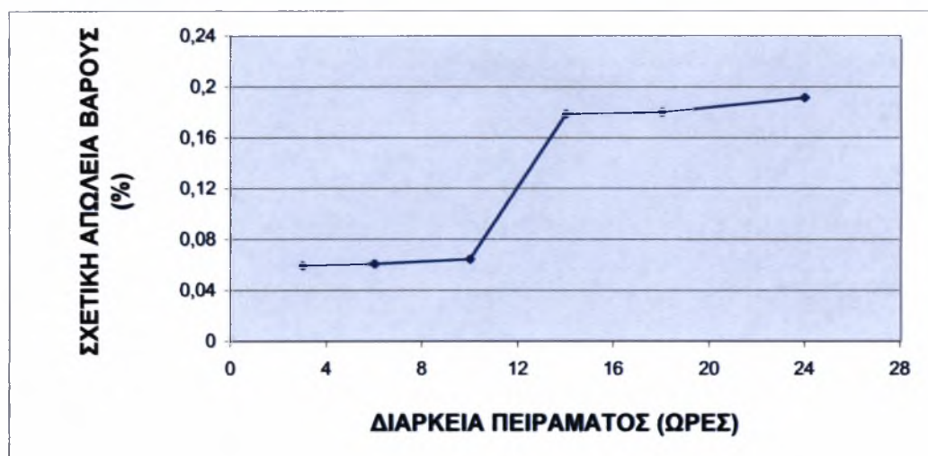
Διάγραμμα 7.4 Μεταβολή της σχετικής (%) απώλειας βάρους των τεμαχίων επιφάνειας 2 του χάλυβα 42CrMo4
