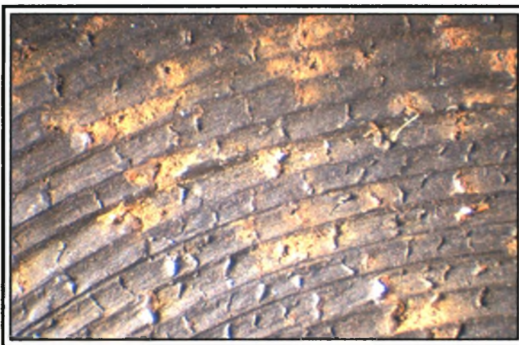
Εικόνα 6.9 Στερεοσκοπία του δοκιμίου 2.1 του υλικού 42CrMo4 μετά την πειραματική διαδικασία. Τρηματική διάβρωση. (x 40)
