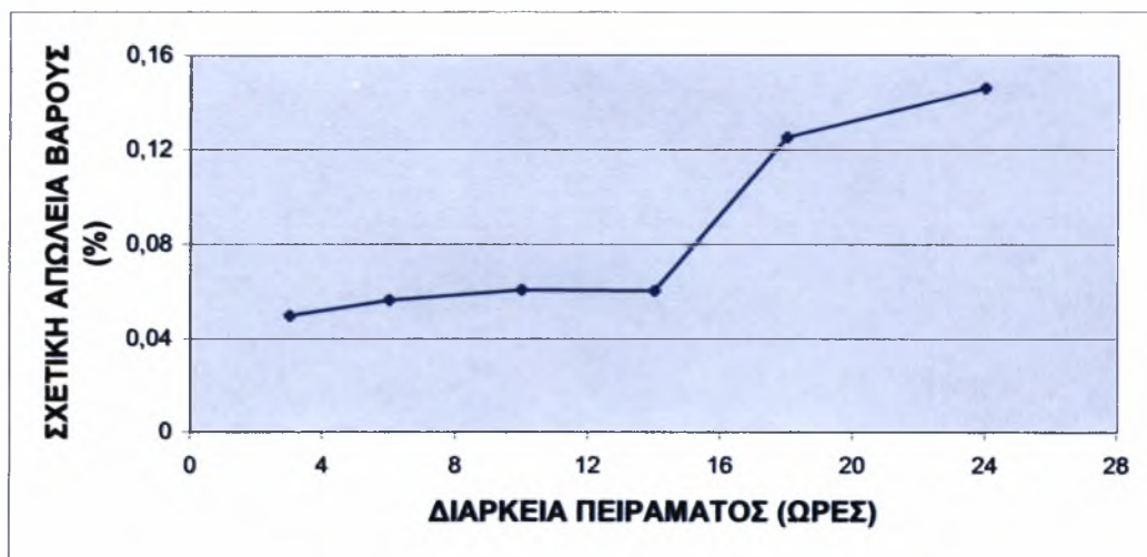
Διάγραμμα 7.16 Μεταβολή της σχετικής (%) απώλειας βάρους των τεμαχίων επιφάνειας 1 του χάλυβα 34CrNiMo6
