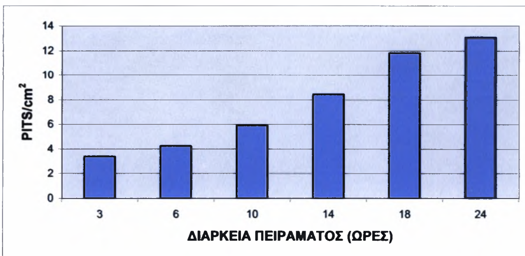
Διάγραμμα 7.20 Μεταβολή των pits/cm 2 των τεμαχίων επιφάνειας 2 του χάλυβα 34CrNiMo6
