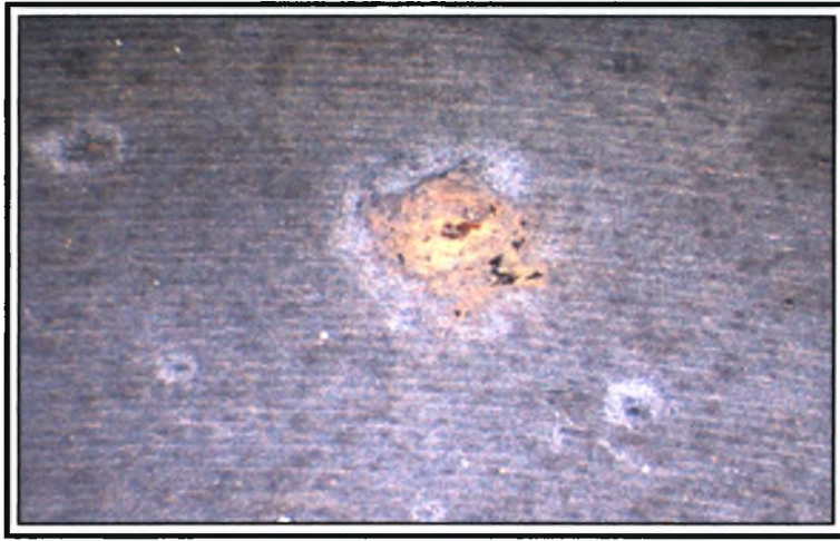
Στερεοσκοπία του δοκμίου 4.4 του υλικού 50CrV4 μετά την πειραματική διαδικασία. Τρηματική διάβρωση. (x 40)
