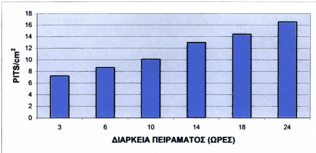
Διάγραμμα 7.35 Μεταβολή των pits/cm 2 των τεμαχίων επιφάνειας 2 του χάλυβα 50CrV4
