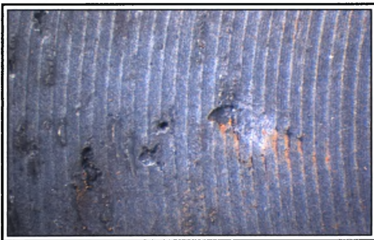
Στερεοσκοπία του δοκμίου 3.6 του υλικού 50CrV4 μετά την πειραματική διαδικασία. Τρηματική διάβρωση. (x 40)
