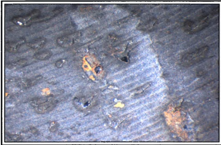
Εικόνα 6.74 Στερεοσκοπία του δοκιμίου 3.3 του υλικού 50CrV4 μετά την πειραματική διαδικασία. Τρηματική διάβρωση. (x 40)
