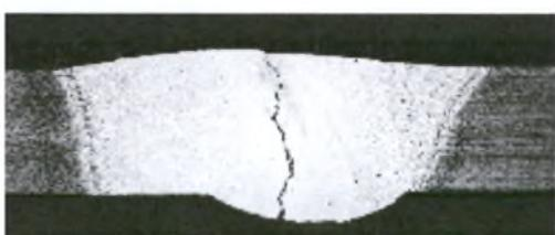
Σχήμα 2-16 : Φωτογραφία συγκόλλησης TIG με παρουσίαση του φαινομένου θερμορωγμάτωσης<sup>16</sup>.
