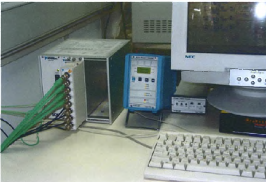
Φωτογραφία 3. Ενίσχυση, φίλτρο, μέρη της πειραματικής διάταξης
