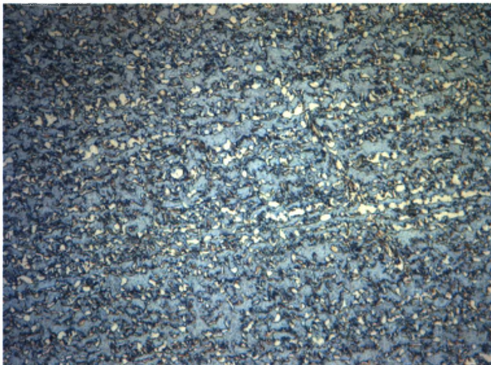
Εικόνα 4.11 Μεταλλογραφία χάλυβα TRIP 700 HR-FH μετά από ενδοκρίσιμη ανόπτηση στους 844°C για 600 sec, μπαινιτικό μετασχηματισμό στους 450°C για 600 sec και χημική προσβολή με LePera για 15 sec, σε μεγέθυνση 1000X.
