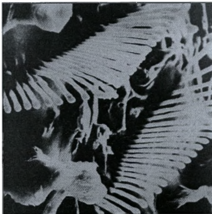
Εικόνα 1.2.2 Έγκλεισμα MnS Type II SEM 1000X [5]
