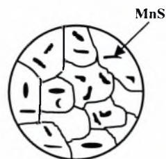
Εικόνα 1.2.5 Έγκλεισματα σουλφιδίου του μαγγανίου
