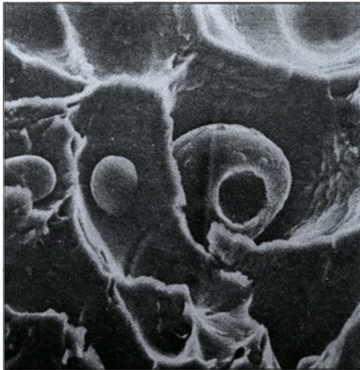
Εικόνα 1.2.1 Έγκλεισμα MnS Type I SEM 1000X [5]
