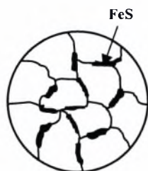
Εικόνα 1.2.4 Έγκλεισματα σουλφιδίων του σιδήρου στα σύνορα των κόκκων
