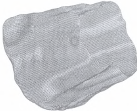
Εικόνα 4.2: Μοντέλο πεπερασμένων στοιχείων όπου οι αρχικές γεωμετρικές ατέλειες έχουν προσομοιωθεί με την ανάπτυξη Karhunen-Loéne
