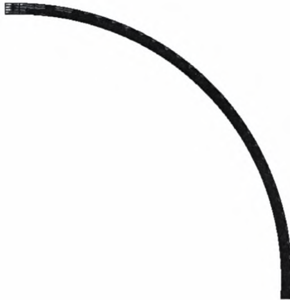
Σχήμα 4.5 Παραμόρφωση του \frac{1}{4} του σωλήνα μετά το βήμα της αποφόρτισης από την περιφερειακή διαστολή, πριν την επιβολή της εξωτερικής πίεσης
