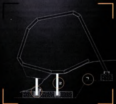
1. ΔΙΑΜΟΡΦΩΣΗ ΕΚΣΚΡΩΣΗΣ ΟΠΟΥ ΕΟΡΑΖΕΤΑΙ Ο ΣΚΕΛΕΤΟΣ ΣΕ ΕΟΡΦΟΣ ΜΕ ΣΗΜΑΝΤΙΚΗ ΚΑΙΣΗ 2. ΒΕΜΕΛΙΩΜΕΝΟ ΜΕΤΑΛΛΙΚΟ ΥΠΟΣΤΗΛΜΑ 3. ΡΜESH ΕΝΤΡΕΧ ΤΟΥ ΥΠΟΣΤΗΛΜΑΤΟΣ ΣΤΟ ΠΕΔΙΑΔ
