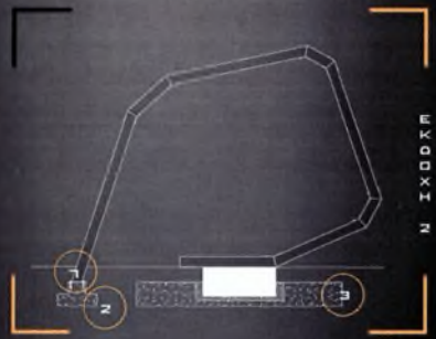
1. ΚΟΡΜΟΣ 2. ΠΕΛΜΗ ΠΕΔΙΑΔΥ 3. ΒΕΜΕΛΙΩΣΗ ΡΩΔ ΟΠΛΙΣΜΕΝΟ ΣΚΥΡΟΔΕΜΑ
