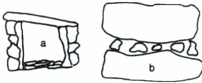
Εικόνα 23. Τομή (a) και κάτοψη (b) μυκηναϊκού οχετού του Μεγάρου Β.
