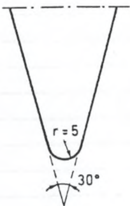
Σχήμα 2.16 Ο διεισδυτής που χρησιμοποιήθηκε για σωλήνες με διάμετρο 324-325 mm
