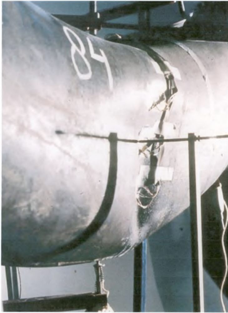
Σχήμα 2.6: Αστοχία δοκιμίου 84 (Local Buckling)
