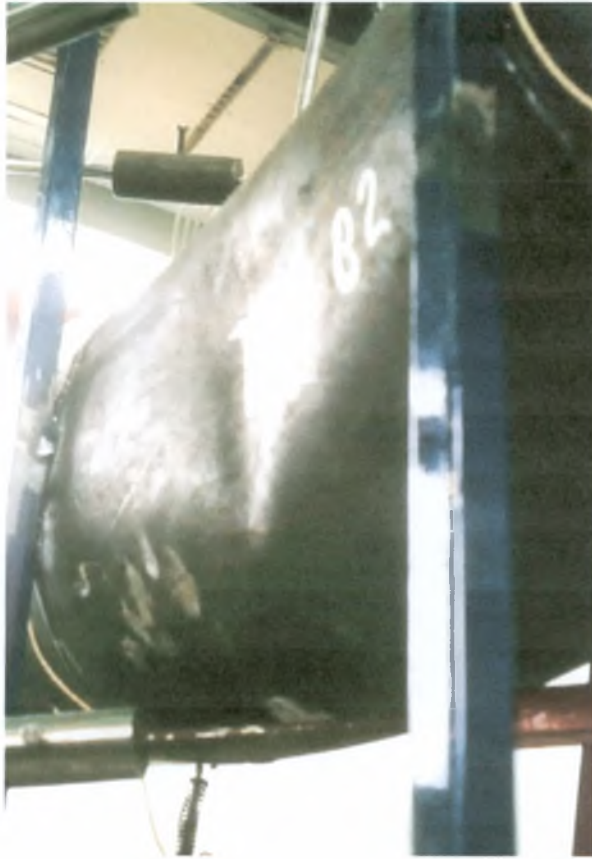
Σχήμα 2.4 : Παραμόρφωση του δοκιμίου 82 στο τέλος του πειράματος
