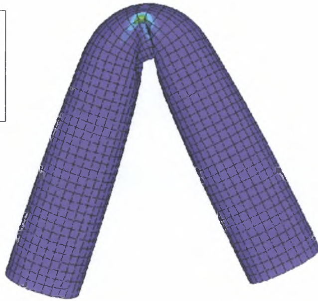
Σχήμα 6.13: Πλήρως παραμορφωμένη κατάσταση στο αριστερό καμπύλο τμήμα του υπέργειου σωλήνα (πέραν της οριακής αντοχής του). Κάμψη στο επίπεδο του καμπύλου τμήματος και πίεση 12 atm. Κατανομή ισοδύναμης πλαστικής παραμόρφωσης.
