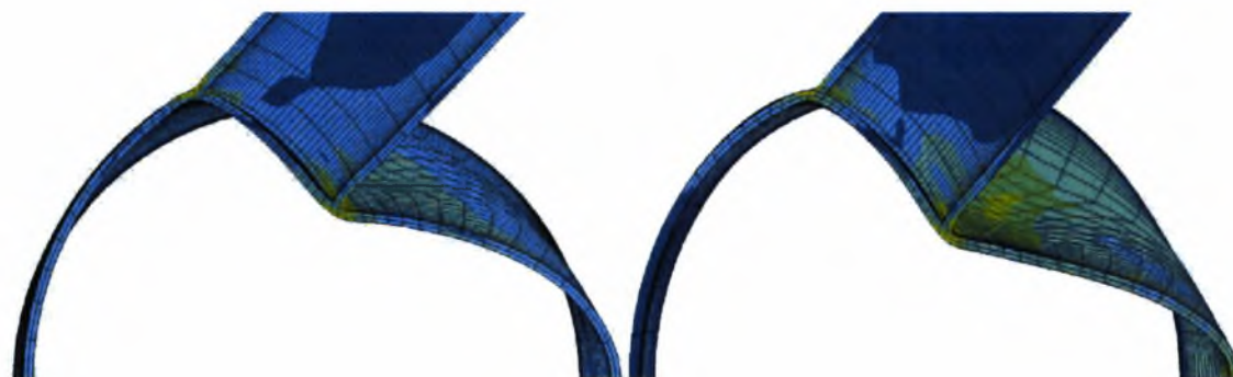
Σχήμα 3-15. Σύνδεσμος μορφής X με \beta=0.33 και \gamma=30 σε εκτός επιπέδου κάμψη στην παραμορφωμένη κατάσταση για πίεση q=0.00 και q=0.51 και στροφή του βραχίονα ίση με \phi=0.76 rad.
