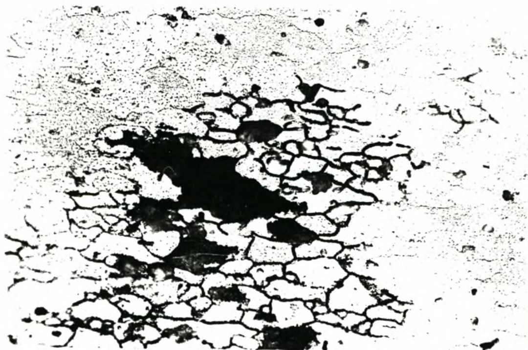
Σχήμα 3.15: Η διάβρωση του δοκιμίου των 45 μερών. Μεγέθυνση: 500X.
