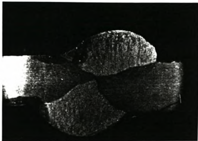
Σχήμα 3.11 : Δοκίμιο Νο4 - 10 φορές μεγέθυνση- Nital 10% 7 sec
