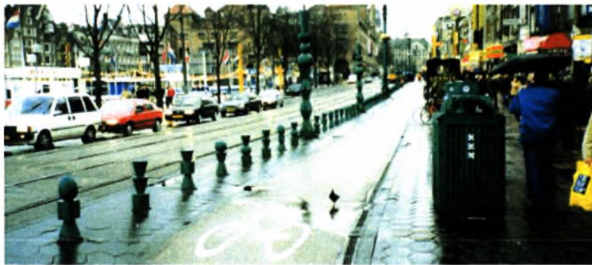
Εικόνα 3. Amsterdam. Ολλανδία. Η οδός Damrak. Κεντρικός άξονας της πόλης, που οδηγεί στον σιδηροδρομικό σταθμό. Η ανάπλαση του δρόμου περιλαμβάνει μια από τις πιο ενδιαφέρουσες, σε ευρωπαϊκή πόλη, λύσεις σχεδιασμού του εξοπλισμού: ενιαία επεξεργασία των φωτιστικών στύλων και των διαχωριστικών στοιχείων μεταξύ της λωρίδας του ποδηλάτου και του διαδρόμου κίνησης του τραμ.
