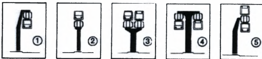
Εικόνα 69: Εναλλαγές τύπων γραμμών PRT. Στην περίπτωση της πρότασης επιλέξαμε τη μορφή 3.
