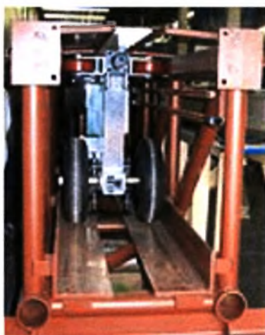
Εικόνα 42. Σύστημα κύλισης για την αποφυγή εκτροχιασμών Πηγή: www.personalrapidtransit.com
