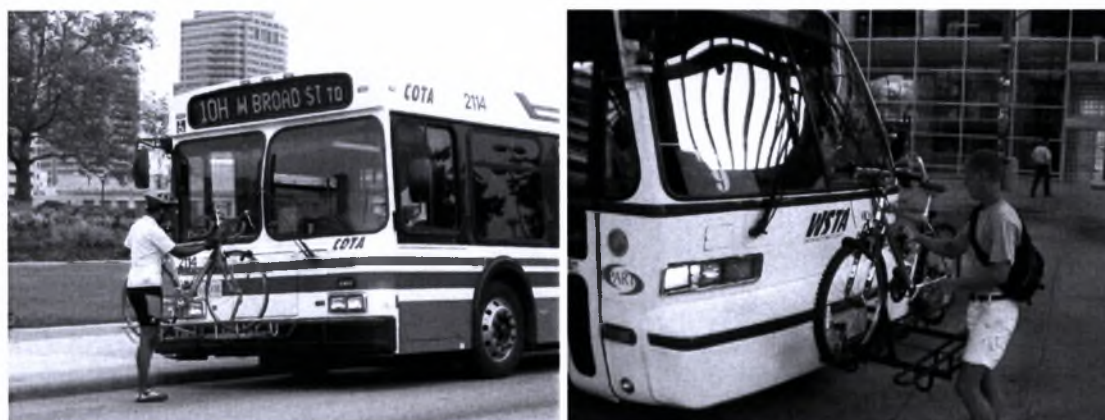
Εικόνα 19. Winston. Salem. Σχάρα ποδηλάτου στο μπροστινό μέρος του λεωφορείου. Πηγή: Schneider, 2005, σελ. 6, 12.
