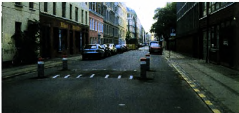
Εικόνα 4. Copenhagen. Δανία. Σαμαράκι που αφήνει ελεύθερους διαδρόμους για τα ποδήλατα στις δύο πλευρές του.
