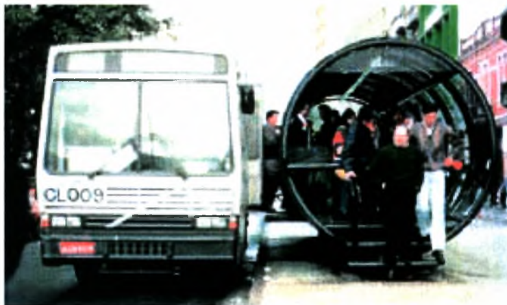
Εικόνα 16. Curitiba. Νότια Βραζιλία. Στάση λεωφορείων express χαρακτηριστικής κυκλικής διατομής που ανεβάζουν τον επιβάτη στη στάθμη του δαπέδου του λεωφορείου. Πηγή: Βλαστός και Μπιρμπίλη, 2001, σελ. 61.
