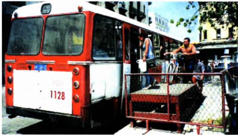
Εικόνα 15. Havana. Κούβα. Ράμπα εισόδου ποδηλάτων σε λεωφορεία των οποίων το εσωτερικό έχει ελάχιστα καθίσματα. Δεδομένου ότι η πόλη, 4 εκατ. κατοίκων, είναι εκτεταμένη, τα λεωφορεία για ποδήλατα δίνουν μια λύση στις μετακινήσεις μεγάλων αποστάσεων. Πηγή: Βλαστός και Μπιρμπίλη, 2001, σελ. 58.
