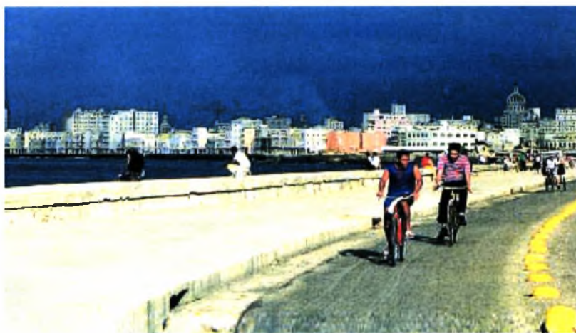
Εικόνα 1. Havana. Κούβα. Λωρίδα ποδηλάτου, πλάτους περίπου 2,5 μ. που ορίζεται από σειρά ημισφαιρικών, κίτρινων στοιχείων από τσιμέντο. Πηγή: Βλαστός και Μπιρμπίλη, 2001, σελ. 32.
