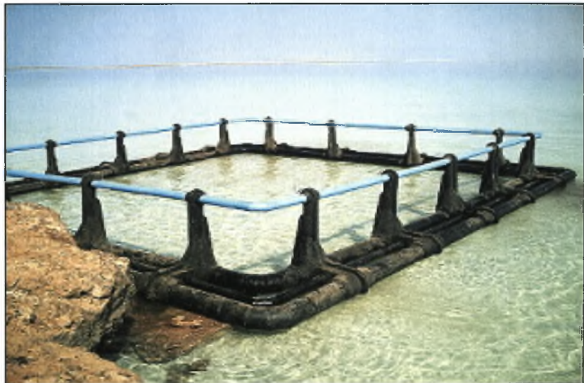
Εικόνα 9: Τετράγωνος πλωτός ιχθυοκλωβός με μήκος πλευράς επτά μέτρα που χρησιμοποιείται για την υποδοχή των ιχθυδίων (Πηγή: Προσωπικό αρχείο).
