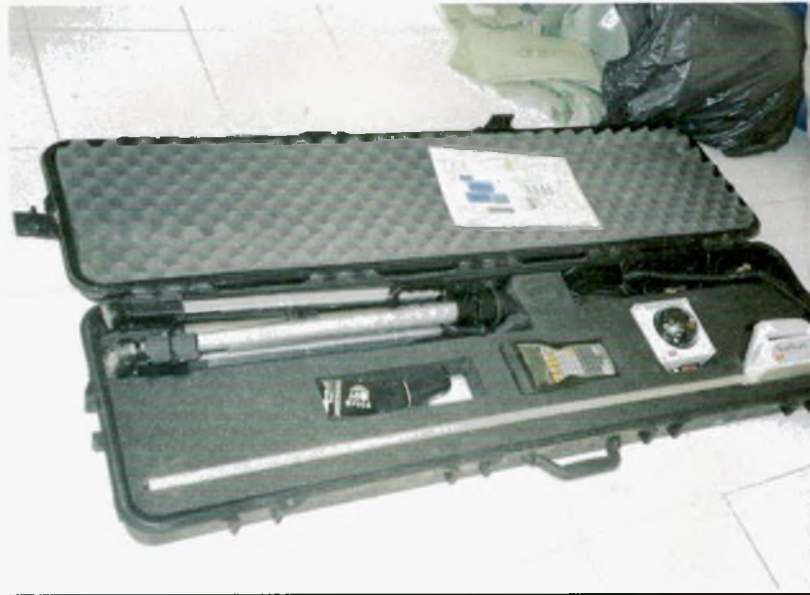
ΕΙΚΟΝΑ 4.10: Αυτόματο όργανο εμβαδομέτρησης LI – COR για τη μέτρηση του LAI.
