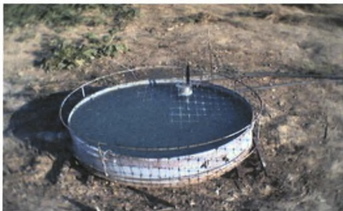
Εικ. 8. Εξατμισόμετρο τύπου A
