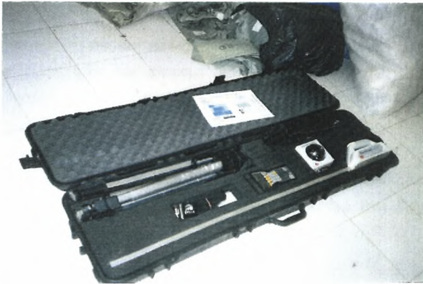
Εικόνα 3.17 Αυτόματο όργανο εμβοδομέτρησης για τη μέτρηση του LAI.
