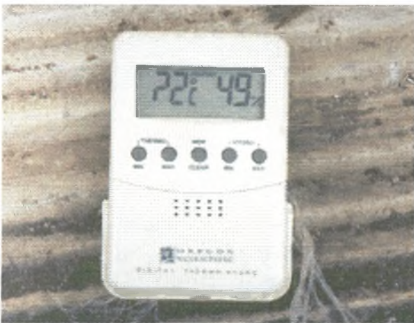
Εικόνα 15. Συσκευή μέτρησης μέγιστης και ελάχιστης θερμοκρασίας και υγρασίας
