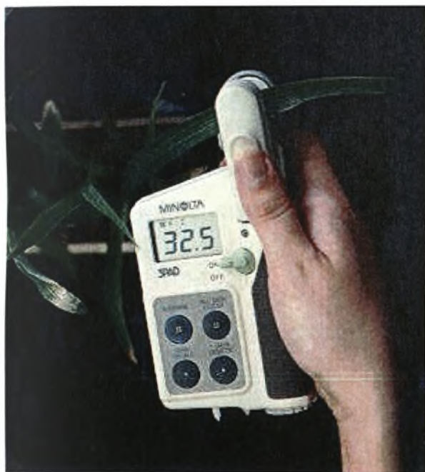
Εικόνα 13. Μέτρηση χλωροφύλλης με το όργανο SPAD (από http://www.maizegdb.org/mnl/68/39krugh.html ).
