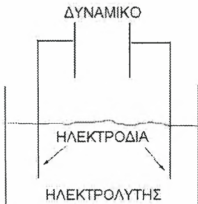
Εικόνα 8: Σχεδιάγραμμα ενός ηλεκτροχημικού θαλάμου. Δύο ηλεκτρόδια τοποθετούνται σε ένα διάλυμα που περιέχει μια ηλεκτρολυτική ένωση.
