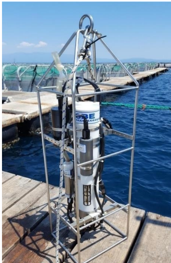
Εικόνα 3. Αυτογραφικό όργανο συνεχούς καταγραφής φυσικοχημικών και βιολογικών χαρακτηριστικών του νερού (CTD, SEABIRD-19plus).
