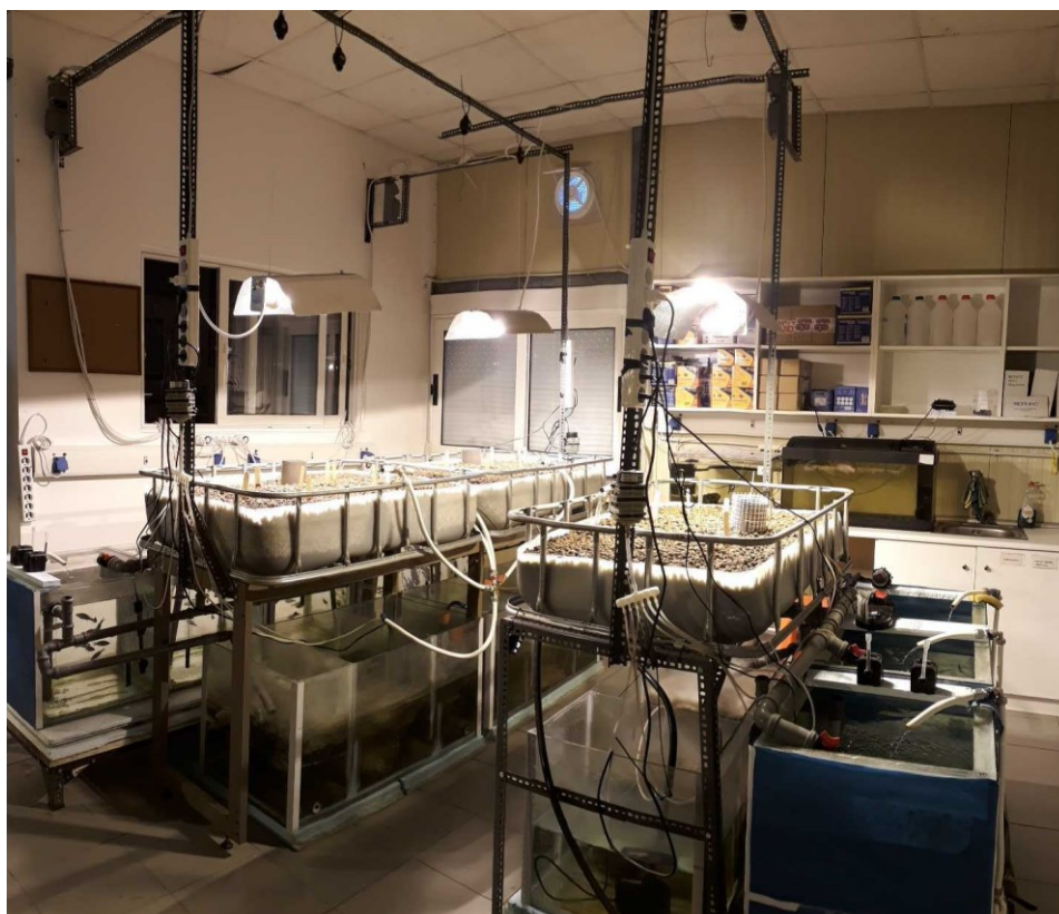
Εικόνα 4.1. Σύστημα ενυδρείοπονίας του Πανεπιστημίου Θεσσαλίας, συνολικού ωφέλιμου όγκου νερού 500L (Προσωπικό αρχείο).
